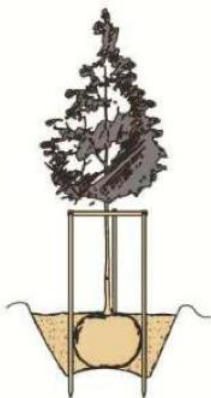
Obr.1 Tvar výsadbovej jamy a kotvenie na tri koly
